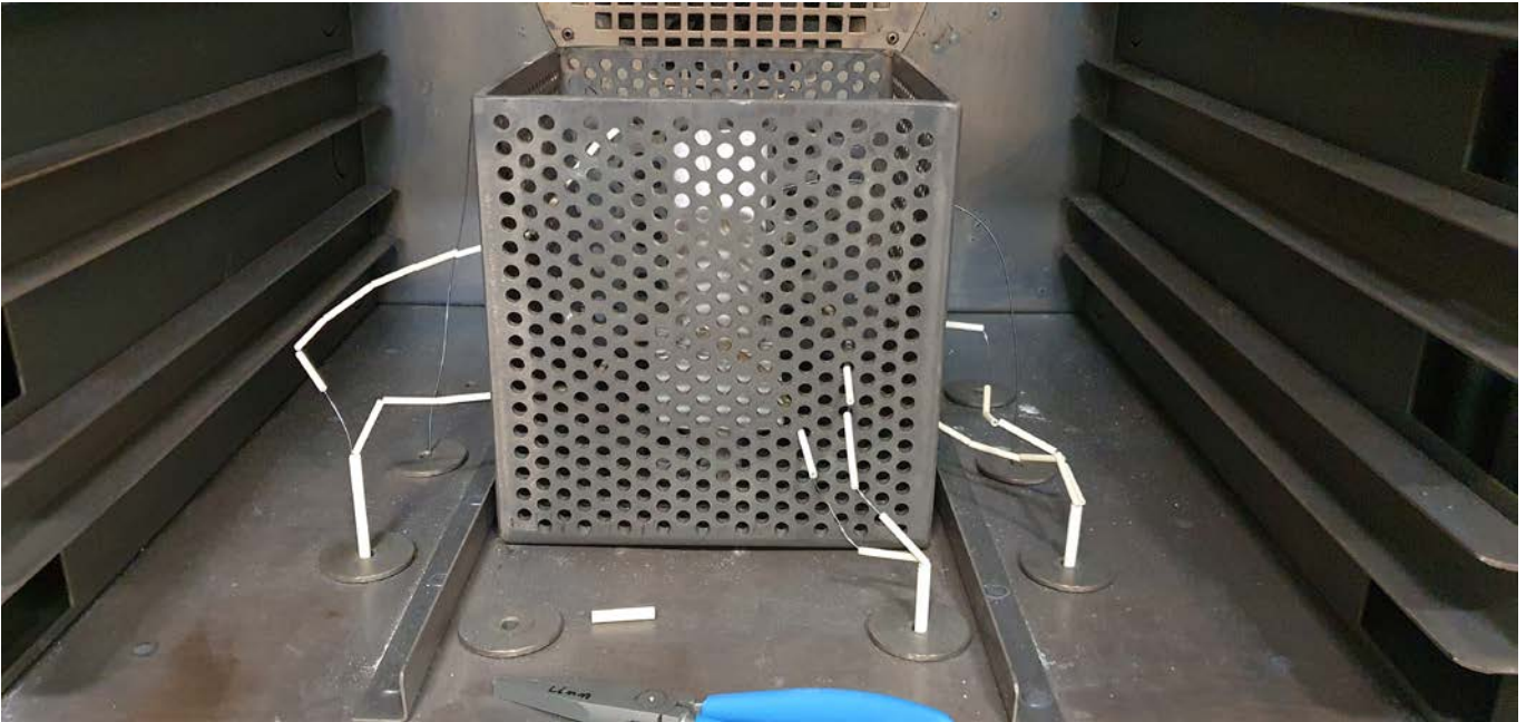
Bild 2: MMH-TG -Druck-EX mit einer Probe der FGF im explosionsicheren Käfig
