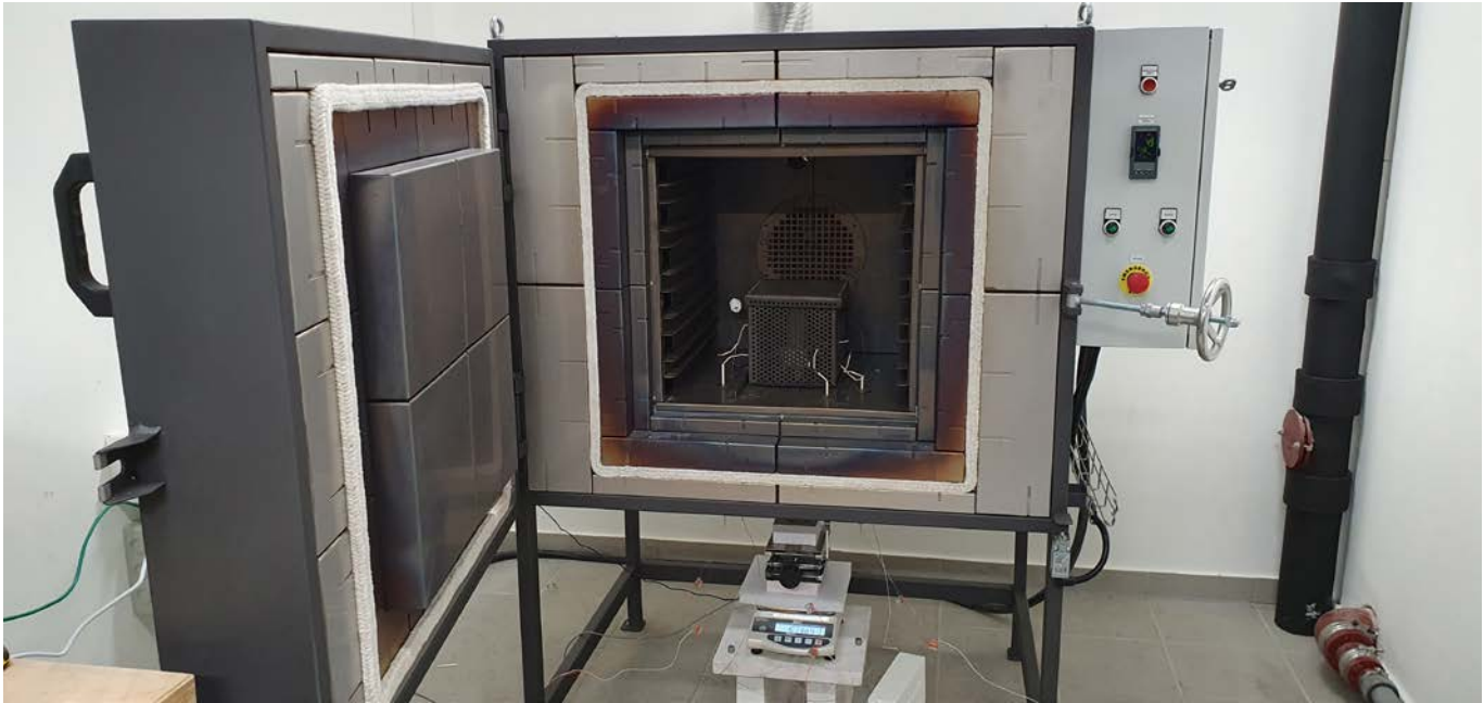
Bild 3: MMH-TG -Druck-EX mit einer Probe der FGF im explosions-sicheren Käfig
